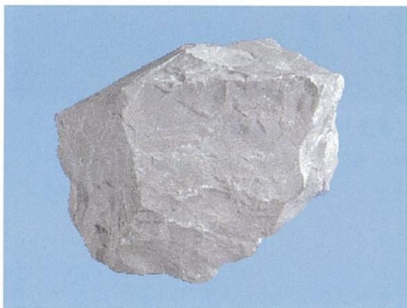
写真 1-1 隠微晶質石灰石
